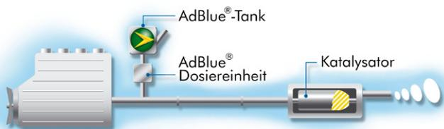
AdBlue® ist ein 32,5% iger Flüssigharnstoff, der zur Reduktion der NOx-Emissionen bei Dieselmotoren eingesetzt wird. Der im Auspuff dosiert eingespritzte Harnstoff ( $(\text{NH}_2)_2\text{CO}$ ) geht im Katalysator unter Hitze eine Verbindung mit Stickoxiden ein. Daraus entsteht zum einen Wasserdampf und zum anderen Stickstoff ( $\text{N}_2$ ). Stickstoff ist absolut unproblematisch, da er mit 78% den Hauptbestandteil der Luft darstellt.
