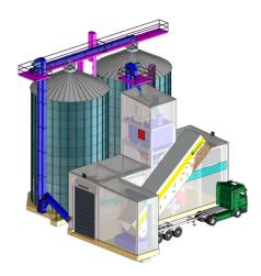
Das Lager umfasst zwei separate Silos, wobei die Lastwagen automatisch beladen werden können.
